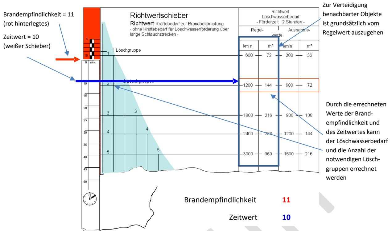
Abbildung 34 Richtwertverfahren erforderliches Löschwasser und Löschgruppen
